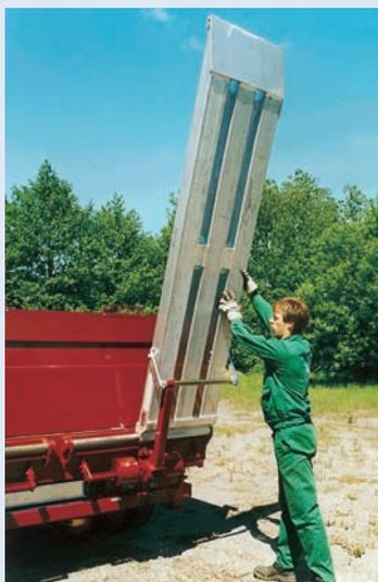
Verladerampen, fest mit dem Fahrzeug verbunden mit Rohranschluss für einen Wellendurchmesser von 60 mm.
