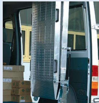
Die Rampe ist sowohl nach außen wie auch ins Fahrzeuginnere drehbar.
