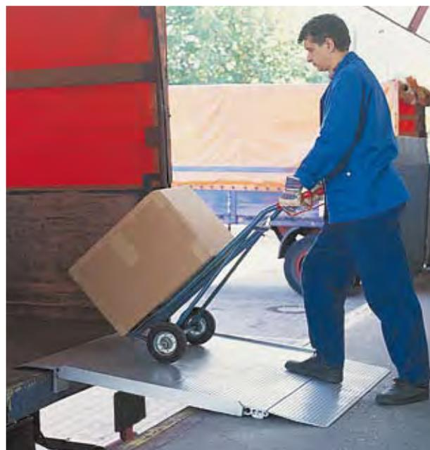
***Le pont en aluminium type HF est construit avec des profilés nervurés et alvéolés de 40 mm d'épaisseur. Tous les profilés sont soudés entre eux, et pour les capacités importantes, des renforts de fortes sections sont soudés en dessous de la plaque.
