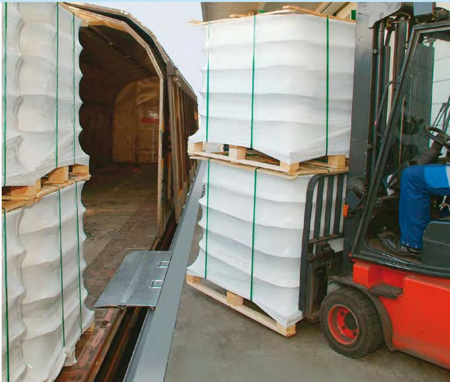
*Le pont type BB est installé dans un rail le long du quai et reste parfaitement bloqué en position repos. Cette plaque oscille à l'intérieur du rail pour rattraper de faibles dénivellations sur un quai de voie ferrée.*
