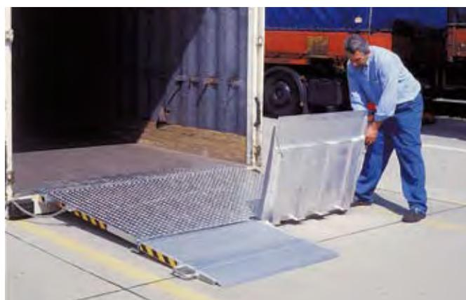
Le pont MC est prévu pour le chargement et le déchargement des containers. Son importante largeur permet un passage optimal pour rentrer ou sortir du container. Deux volets articulés en aluminium se rabattent sur le plateau en acier galvanisé et laissent ainsi le passage libre sous le plateau pour passer les fourches du chariot élévateur afin de faciliter le déplacement du pont.
