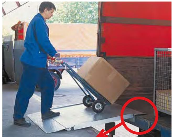
La lèvre d'appui doit reposer sur le plancher du camion d'au moins 100 mm (maxi 150 mm)
