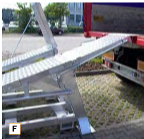
Rampes de chargement mobiles en deux parties, articulées, non compensées.
