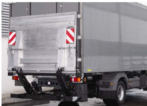
Plate-forme en 2 parties pouvant être positionnée verticalement et pivotante
